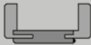
Zarge mit Schließblech in Weiß, Verstellbereich -5/+15 mm, Designkante, Futterplatte mit kl. Rundkante (60 mm)
