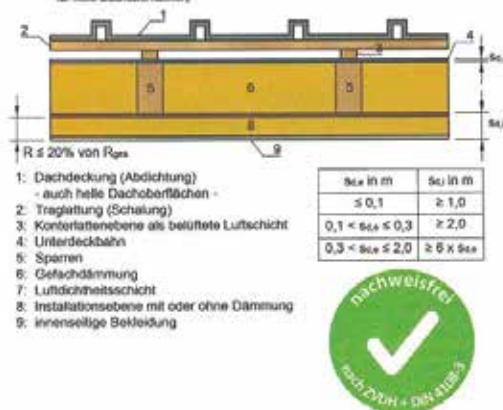
Abb. 12: Nachweisfreie Dächer mit Gefachdämmung – Luftdichtheitsebene unterhalb des Sparrens (auch für helle Dachoberflächen)
