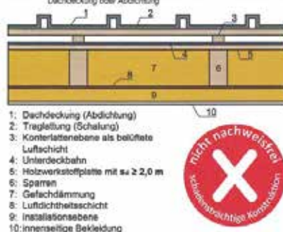
Abb. 7: Nicht belüftetes Dach mit regensichernder Zusatzmaßnahme auf Holzwerkstoffplatte und Dachdeckung oder Abdichtung
